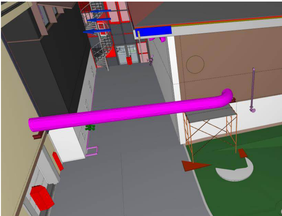
Figur 5. Omløpsledning mellom eksisterende grovrister og flokkuleringskammer. Rørledning vist med magenta farge.
